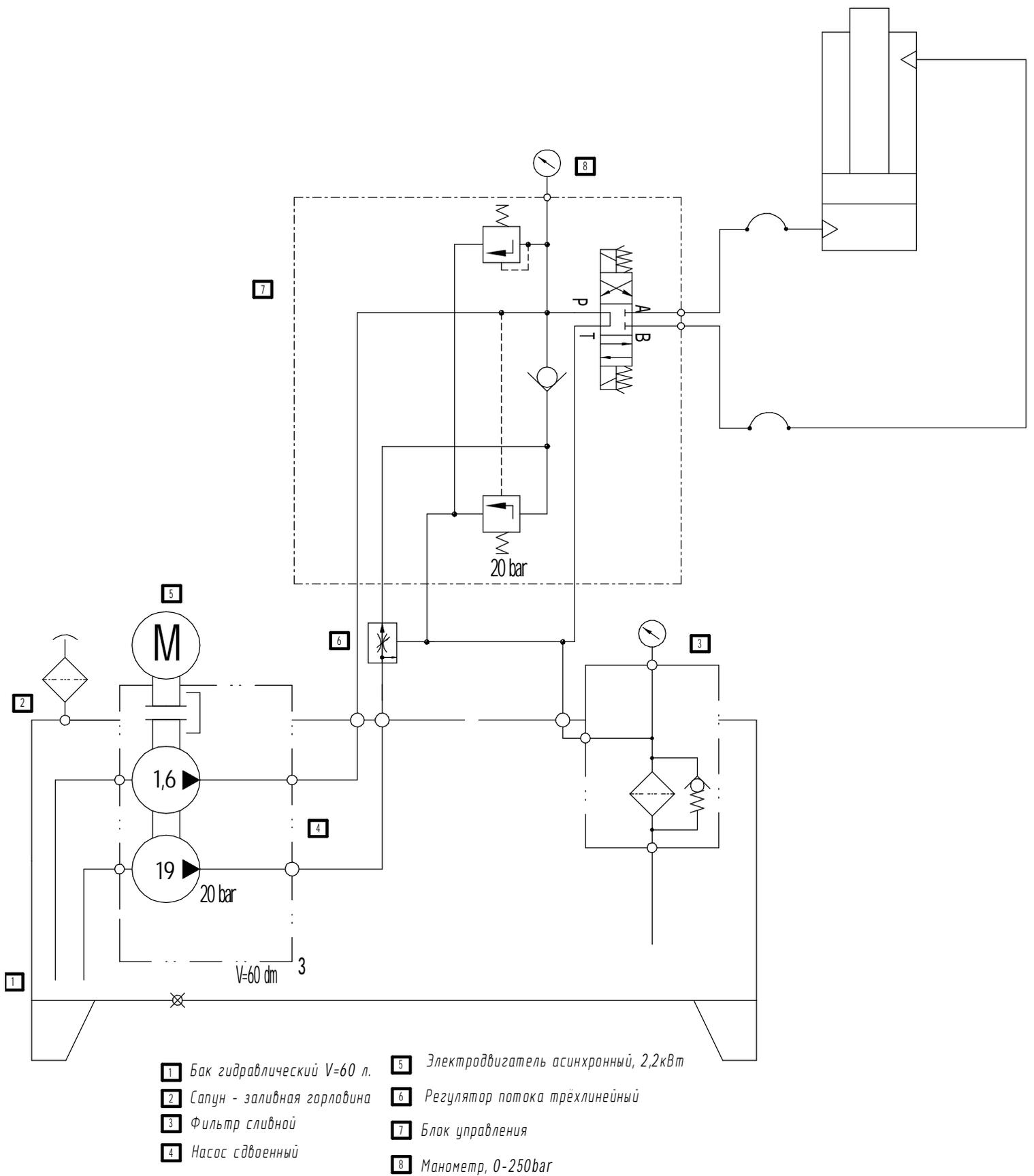
Рис. 2.1. – схема гидростанции гидравлическая принципиальная
